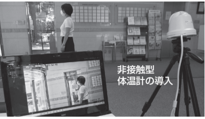
非接触型体温計の導入 発熱者が通るとパソコン画面が赤く光り、体調不良者をチェックできます。(松戸キャンパス)
